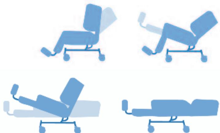
Die durchdachte Mechanik des Neigungs-Systems erlaubt die stufenlose Verstellung der Rückenlehne von der Sitzposition (selbst mit Beinhochlagerung) in die Liegeposition, sowie beliebige Sitzneigungen. Ein Kippen über Kopf wird durch ein durchdachtes Sperrsystem in der Hydraulik verhindert.
