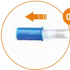
**02** Ventil durch Ziehen öffnen und ca. 30 Sekunden warten, bis sich die Luftkissen selbstständig aufgeblasen haben. (Ventilkappe kann nicht herunterfallen.)
